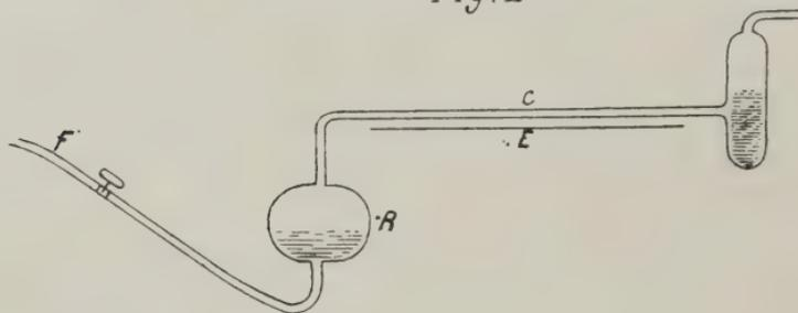
La lumière placée en L agit sur les gaz du photomètre placé en R entre les pôles par l'ouverture de 15 millimètres de diamètre indiquée en pointillé sur la figure 5 et qui perce les pièces polaires; ce sont les ouvertures qui servent pour les expériences sur la lumière polarisée;
